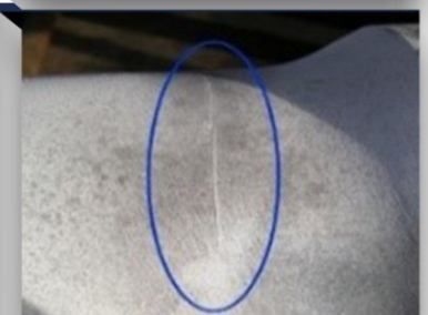
Crack ( fatigue crack)
